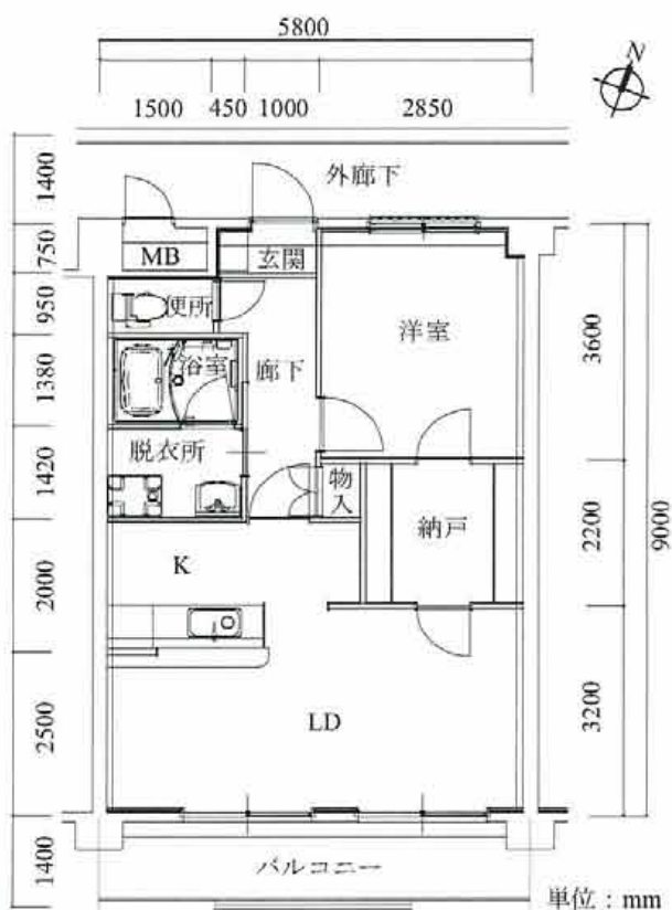
図. 3. RC造集合住宅の102・105号室の平面図。
