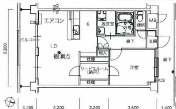
図 1 102・105 室の平面図および観測点
